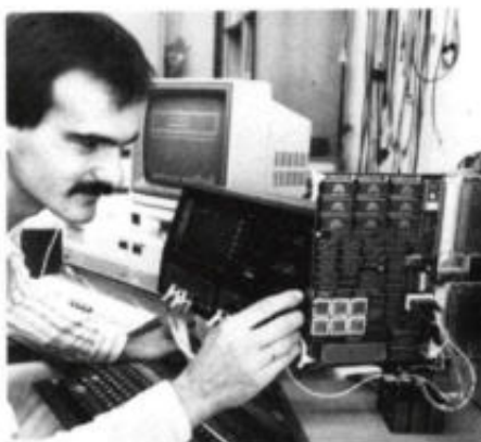
Een kaart met een nieuw ontwikkelde bit-slice-processor met een woordbreedte van 16-bit ondergaat de laatste functionele proeven met behulp van een logica-analysator (foto AEG).
