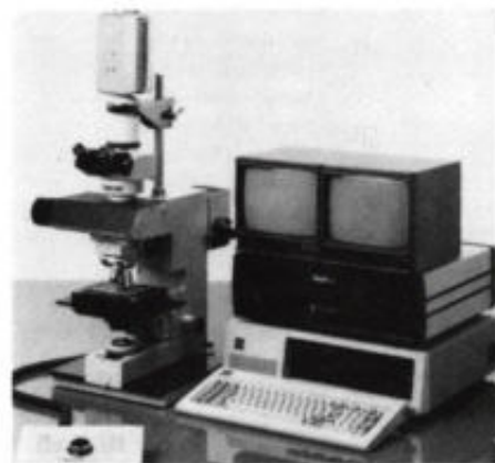
Afb. 5. Digitale vlakheidsanalysator van Matra GCA, voor automatische vlakheidsmeting van wafers, fotomaskers en reticles.
