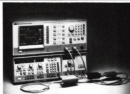
Afb. 5. HP's volledig programmeerbare scalaire netwerkanalysator HP8756A met directionele 26,5 GHz-meetbrug HP85021A en zwaai-generator HP8350B.
