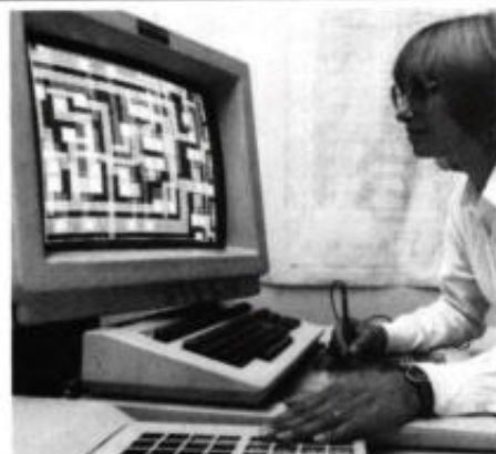
MOS-structuren van een signaalprocessor op het beeldscherm van een interactief CAD-ontwerpstation (foto: AEG).
