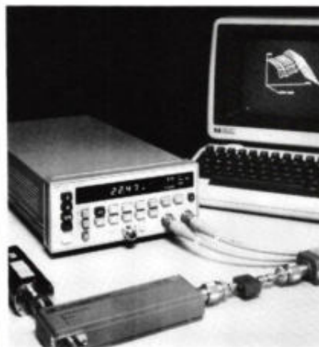
Afb. 9. Tweekanaals vermogenmeter HP438A in een meetopstelling voor geautomatiseerde metingen aan een microgolfversterker. Het instrument meet het ingangs- en uitgangsvermogen en berekent de versterking en de versterkingscompressie. De computer tekent op het beeldscherm het versterkingsprofiel als functie van het ingangsvermogen (waarbij de compressie zichtbaar wordt) en als functie van de frequentie (foto: Hewlett-Packard).
