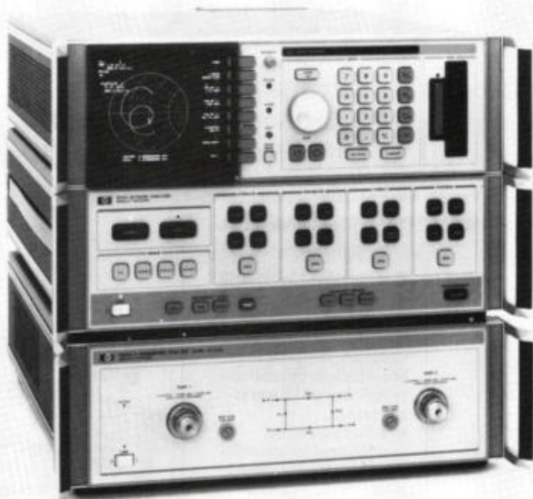
Afb. 1. Netwerkanalysator HP8510A met meeteenheid voor s-parameters. Eén van de belangrijke „extra's" van dit systeem is de mogelijkheid tot analyse in het tijddomein, zie ook afb. 2 (foto: Hewlett-Packard).
