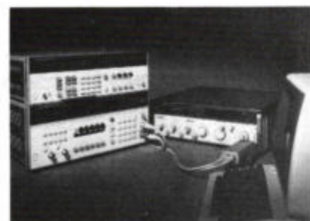
Afb. 14. Het meetsysteem HP8952S van Hewlett-Packard is opgebouwd uit een meetontvanger en een audio-analysator, met welke combinatie men signaalgeneratoren (inclusief de AM- en FM-modulatieparameters) kan ijken in een frequentiegebied van 0,150 ... 1300 MHz.
