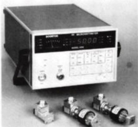
Afb. 8. Met de voor twee sensoren geschikte HF-microwattmeter Boonton 4200 is het mogelijk vermogensverhoudingen te meten, bijvoorbeeld voor het bepalen van de versterkings- of reflectieparameters van een component.
