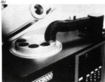
Afb. 1. De 8000-serie van Plasma Technology omvat verschillende apparaten voor plasma-bewerkingen die zijn uitgerust met een specifiek voor het hanteren van silicium- en GaAs-wafers ontworpen robotarm. Afb. (a) toont de robotarm in een geopende uitvoering; voor toepassing in een stofvrije ruimte is de arm volledig afgeschermd door een flexibele slang (b).
