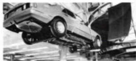
In de Daimler-Benz rij simulator wordt een echte auto - zonder motor, assen en aandrijving - als 'werkplaats' voor de bestuurder gebruikt.
