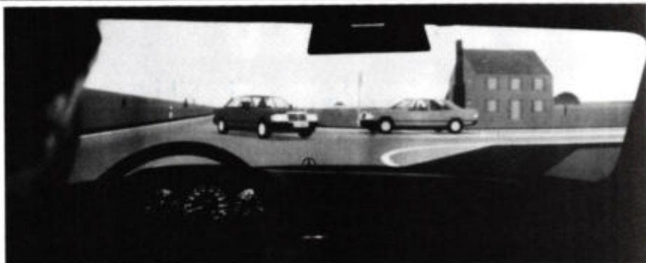
Het digitale beeldsysteem berekent in 80 milliseconden telkens opnieuw een beeld dat via 6 video-projectoren op een halfcirkelvormig beeldvlak over 180° wordt afgebeeld.
