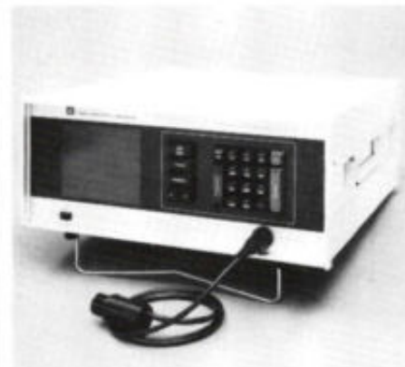
Afb. 7. Automatische piekvermogenmeter 478A, geschikt voor meting van impulsvermogens met frequenties van 0,75 ... 18,6 GHz (foto: General Microwave Co.).
