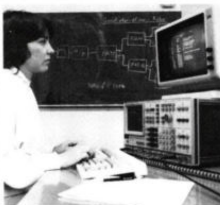
Programmatuurontwikkeling voor een filterconfiguratie van het autotelefoniesysteem CD900. De bandbreedte van de signaalverwerking bedraagt 300 Hz ... 3,4 kHz. Een signaalprocessor realiseert hier onder programmabesturing de gewenste filterkarakteristiek. De spectrum-analysator maakt directe controle van de programmeerresultaten mogelijk.
